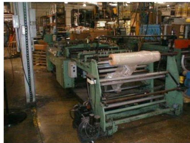
Σχήμα 30: Τυπική συσκευή παρασκευής φιλμ (σακούλες) κατάλληλοι για ανακυκλωμένα πλαστικά
