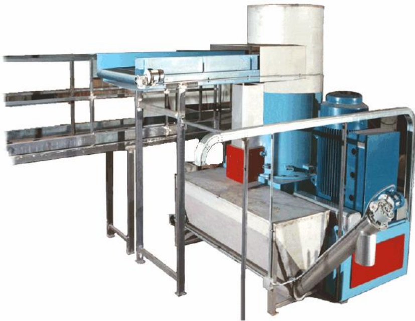
Σχήμα 25: Τυπικός συσσωματοποιητής ασυνεχούς λειτουργίας κατάλληλος για ανακυκλωμένα πλαστικά
