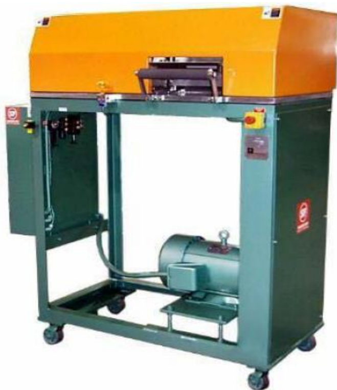
Σχήμα 24: Τυπικοί πελλετοποιητές κατάλληλοι για ανακυκλωμένα πλαστικά
