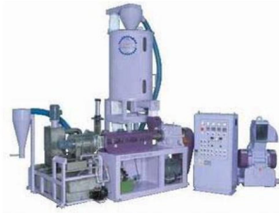
Σχήμα 32: Καθετοποιημένη μηχανή ανακύκλωσης μικρού μεγέθους
