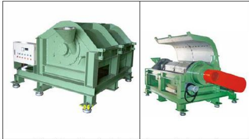
Σχήμα 21: Τυπικοί ξηραντήρες (hydro-extractors) για ανακυκλωμένα πλαστικά
