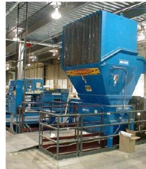
Εχίμα 13: Τυπικός θρυμματιστής κατάλληλος για ανακυκλωμένα πλαστικά
