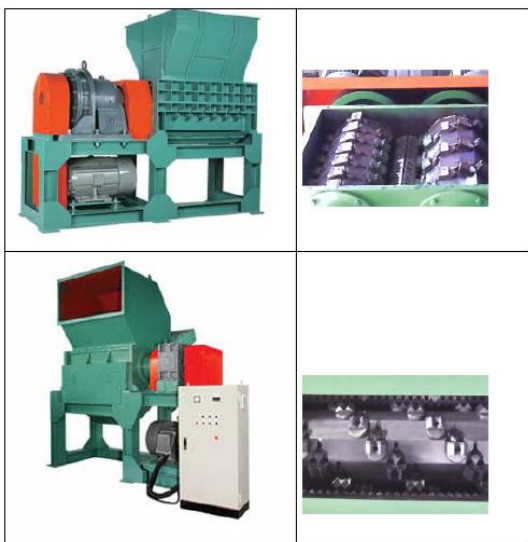
Εἶγμα 14:Τυπικοί θρυμματιστές κατάλληλοι για ανακυκλωμένα πλαστικά
