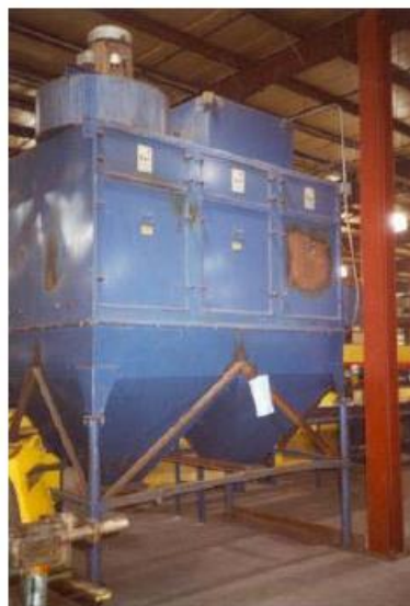
Εἶγμα 17:Τυπικός συλλέκτης σκόνης κατάλληλος για ανακυκλωμένα πλαστικά
