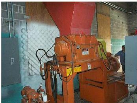
Εἶγμα 16: Τυπικός κοκκοποιητής κατάλληλος για ανακυκλωμένα πλαστικά
