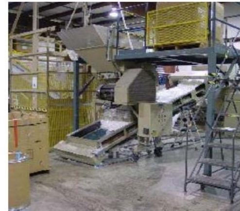
Εχίμα 12: Τυπικός θρυμματιστής κατάλληλος για ανακυκλωμένα πλαστικά
