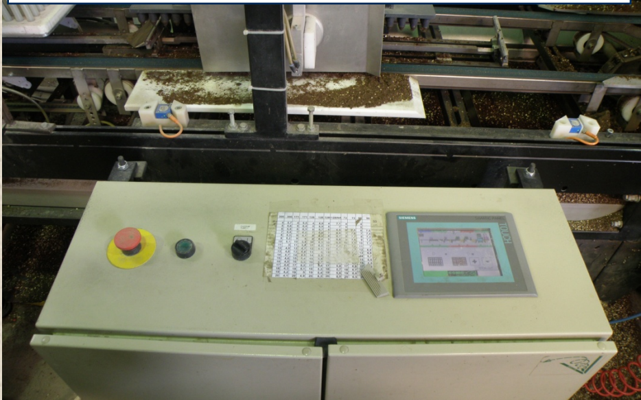
Αυτόματος έλεγχος μηχανής σποράς
