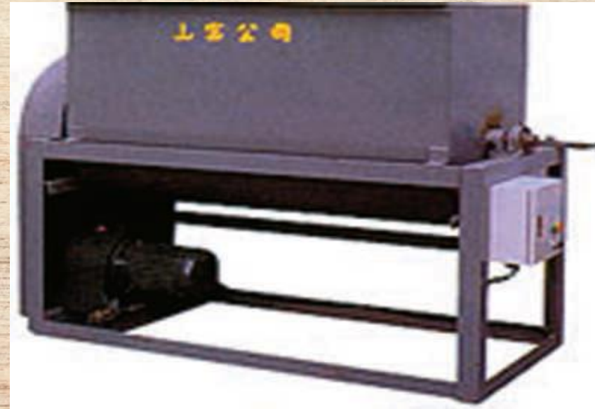
Μηχανή ανάμειξης ξυλοτεμαχιδίων με συγκολλητική ουσία
