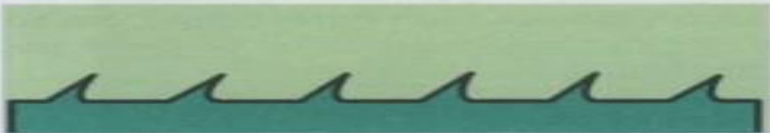
γ. Για πρίση κορμών ελαφρών ξύλων μεγάλης διαμέτρου.
