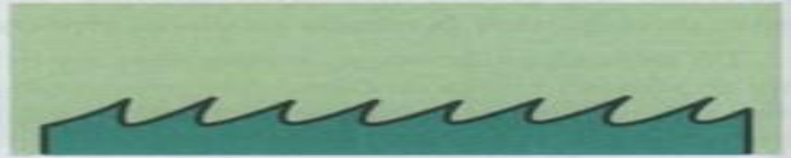
β. Για πρίση κορμών ελαφρών ξύλων μικρής διαμέτρου.
