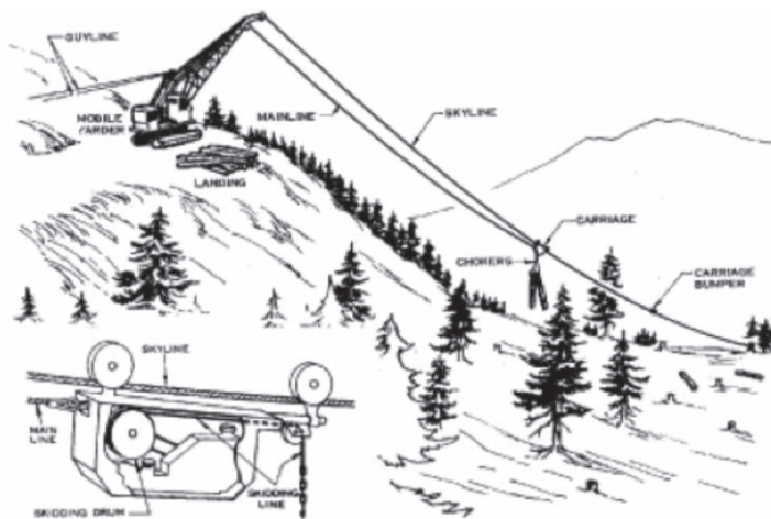
Εικόνα 14. Μετατόπιση ξύλου με φορτάμαξα (Πηγή: Clayoquot Sound Scientific Panel)
