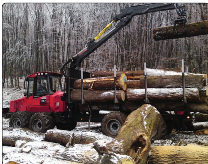
Εικόνα 10. Γερανοφόρος ελκυστήρας με σφιγκτήρα (KOMATSU 840.4). Πηγή: S.C. ALSER FOREST S.R.L.
