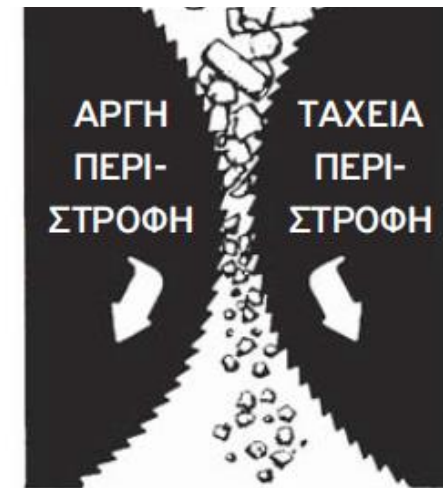
Εικόνα 9.10. Η λειτουργία των κυλίνδρων του θρυμματιστή
