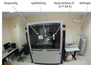
Σύστημα κρυσταλλογραφίας Εργαστηρίου Φυσικής ΓΠΑ
