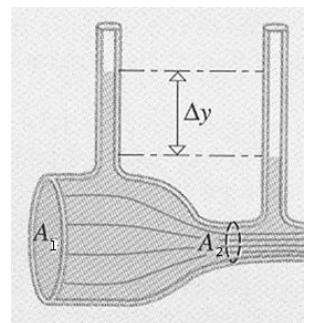
**10. (εξετάσεις Φεβ. 2015)** Πόση θα πρέπει να είναι η διάμετρος μιας οπής που θα ανοίξουμε στην πλευρική επιφάνεια μεγάλης, ανοικτής δεξαμενής νερού,  $7,2 \text{ m}$  κάτω από την ελεύθερη επιφάνεια του νερού ώστε να έχουμε παροχή νερού ίση με  $180 \text{ L/min}$ ;
