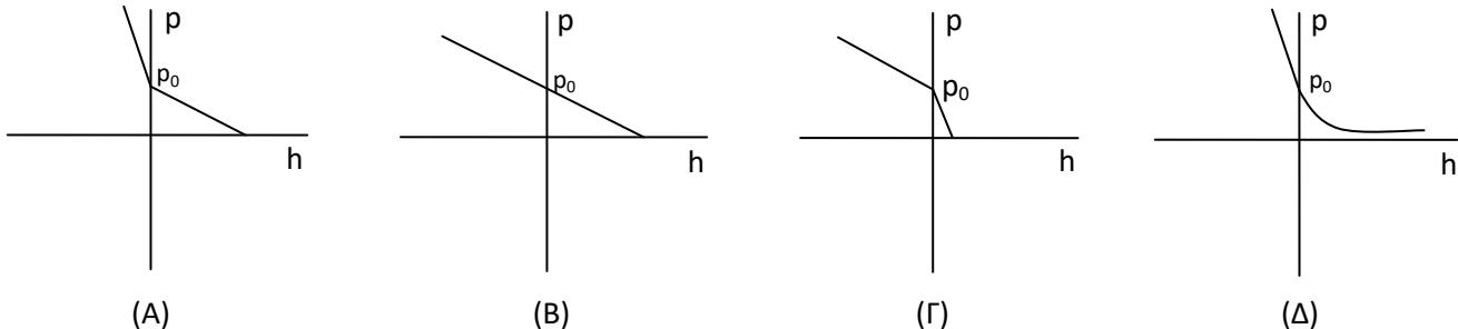
3. I) Ποιο από τα ακόλουθα διαγράμματα αποδίδει ορθότερα την υδροστατική πίεση σε συνάρτηση με το βάθος σε μίγμα λαδιού-νερού στο οποίο η διεπιφάνεια λαδιού-νερού παρατηρείται σε βάθος  $h_1$  από την επιφάνεια του μίγματος στον αέρα;
