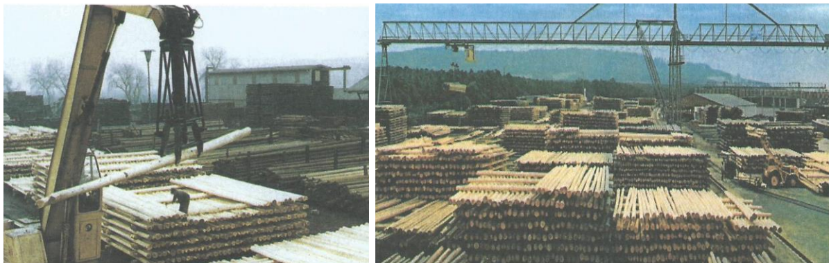
Εικόνα 9.3 Κατάλληλη στοιβασία ξύλινων στύλων πεύκης για φυσική ξήρανση πριν τον εμποτισμό σε κορμοπλατεία εργοστασίου (Κακαράς, 2009).
