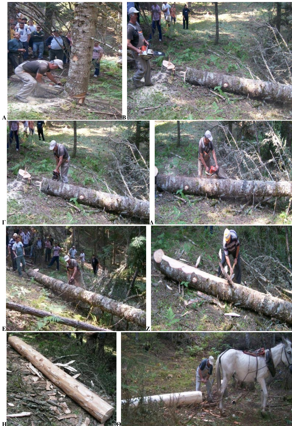
Εικόνα 3.9 Διαδικασία ρίψεως και διαμορφώσεως ενός δέντρου ελάτης. Α,Β: ρίψη και πτώση του δέντρου, Γ: επιπεδοποίηση βάσης, Δ: αποκλάδωση, Ε: τεμαχισμός, Ζ: αποφλοιώση, Η: αποφλοιωμένο κορμοτεμάχιο, Θ: μετατόπιση κορμοτεμαχίου από το υλοτόμιο στο δασόδρομο (Βουλγαρίδης, 2015).
