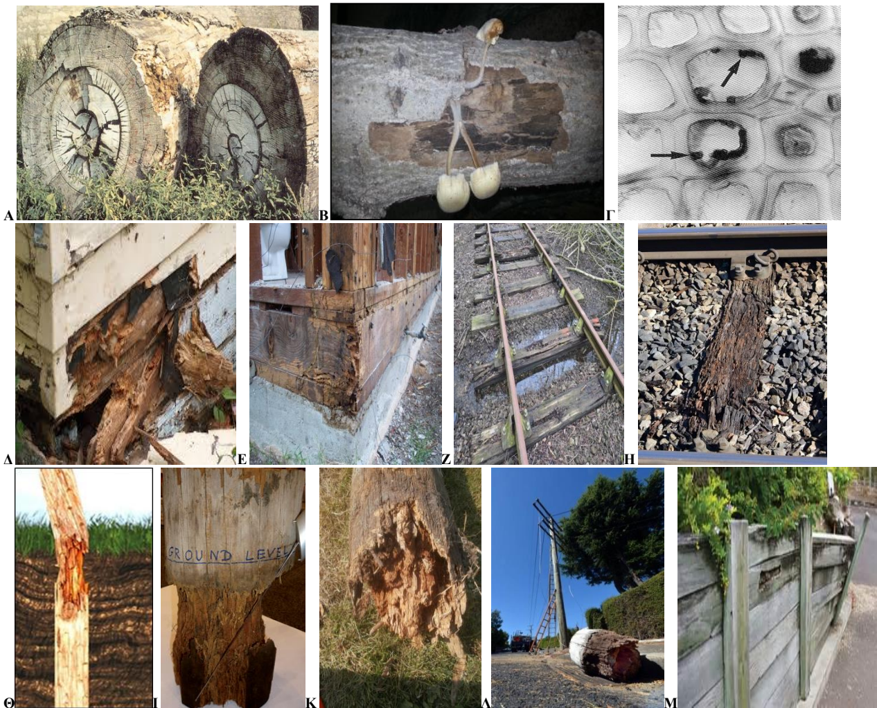
Εικόνα 3.14 Μακροσκοπική εμφάνιση προσβολής από σηπτικούς μύκητες (Α) σε εγκάρσιες τομές κορμοτεμαχίων. Β. Προσβολή κορμοτεμαχίου από μύκητα και δημιουργία καρποσώματος. Γ. Προσβολή κυτταρικών τοιχωμάτων από την εσωτερική πλευρά σε μικροσκοπικό επίπεδο. Γ-Α. Σήψη ξύλινων κατασκευών- βάσεις ξύλινων οικημάτων (Γ,Δ), στρωτήρων σιδηροδρόμων (Ε,Ζ), στύλων τηλεπικοινωνιών και εξηλεκτρισμού (Η-Κ) και ξύλινου φράκτη κήπου (Λ). Παρατήρηση την ευαίσθητη περιοχή μωκητικής προσβολής σε στύλους, πάνω και κάτω από την επιφάνεια του εδάφους (Η,Θ), την πλήρη αποδιοργάνωση του ξύλου μετά από σήψη (Ι) και την πτώση στύλου ΔΕΗ λόγω σήψεως (Κ)(Βουλγαρίδης, 2015).
