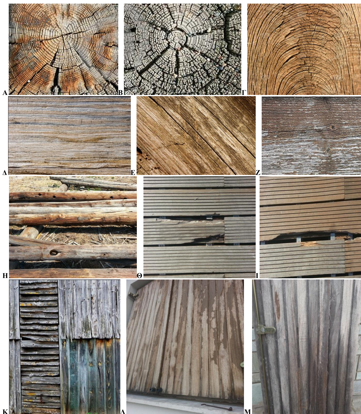
Εικόνα 5.7 Μακροσκοπική εμφάνιση επιφανειών ξύλου, οι οποίες λόγω φυσικής γήρανσης (natural weathering), εμφανίζονται αλλοιωμένες, μεταχρωματισμένες, τραχείες και με ραγαδώσεις. Α,Β,Γ: Εγκάρσιες επιφάνειες. Δ,Ε,Ζ: Πλευρικές (αξονικές) επιφάνειες. Η: Φυσική γήρανση στύλων ΔΕΗ. Θ,Ι: Αλλοιώσεις και απομάκρυνση τμημάτων ξύλου από υπαίθριο δάπεδο στη νέα παραλία Θεσσαλονίκης. Κ,Λ,Μ: Αλλοιώσεις εξωτερικών επενδύσεων και παραθυρόφυλλων (παντζουριών). Το βερνίκι των παραθυρόφυλλων σε οικία στον Πολύγυρο Χαλκιδικής έχει μερικώς (Α) ή ολικώς (Μ) απομακρυνθεί και οι επιφάνειες των ξύλων έχουν αλλοιωθεί λόγω της επίδρασης των φυσικών παραγόντων (Βουλγαρίδης, 2015).
