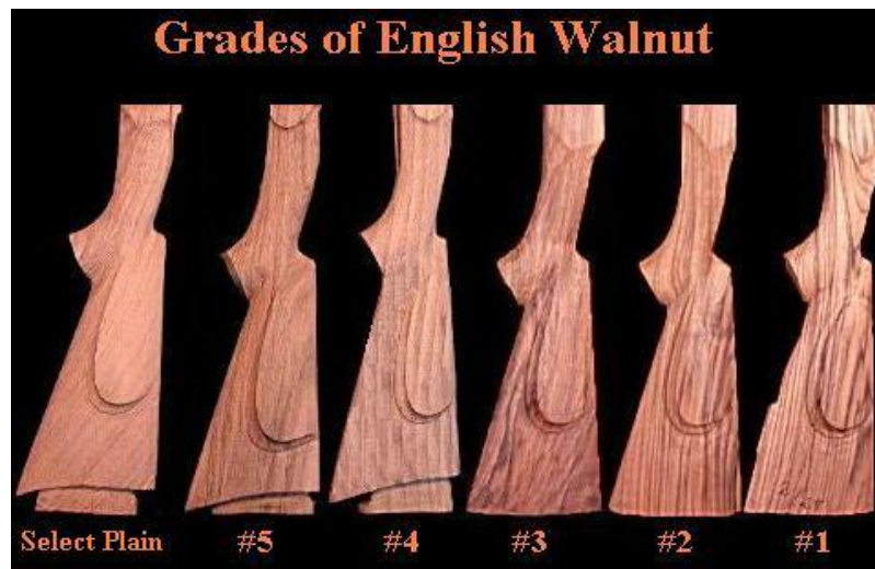
Εικόνα 7.3 Α. Ποιοτική ταξινόμηση τεμαχισμένων προπλασμάτων καρδιάς κοντακιών όπλων σε μια βιομηχανία. Β. Σύστημα ποιοτικής ταξινόμησης πλήρως διαμορφωμένων κοντακιών καρδιάς (από Βασιλείου & Αϊδινίδης, 2004).
