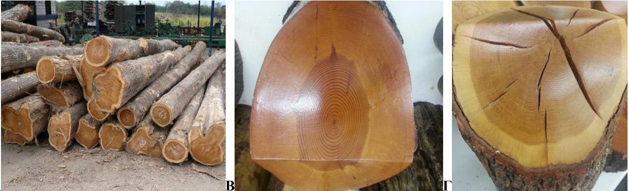
Εικόνα 1.3 Α. Χρωματιστό εγκάρδιο ξύλο (κεντρικά) και σομφό ξύλο, ανοικτού χρώματος (περιφερειακά), όπως φαίνεται σε εγκάρσιες τομές κορμοτεμαχίων τροπικής ζυλίας (Φρόγκος 2011). Χρωματιστό εγκάρδιο και σομφό ξύλο σε (Β) κωνοφόρο (πέυκη) και σε (Γ) πλατύφυλλο (δρυς) είδος (Βουλγαρίδης, 2015).
