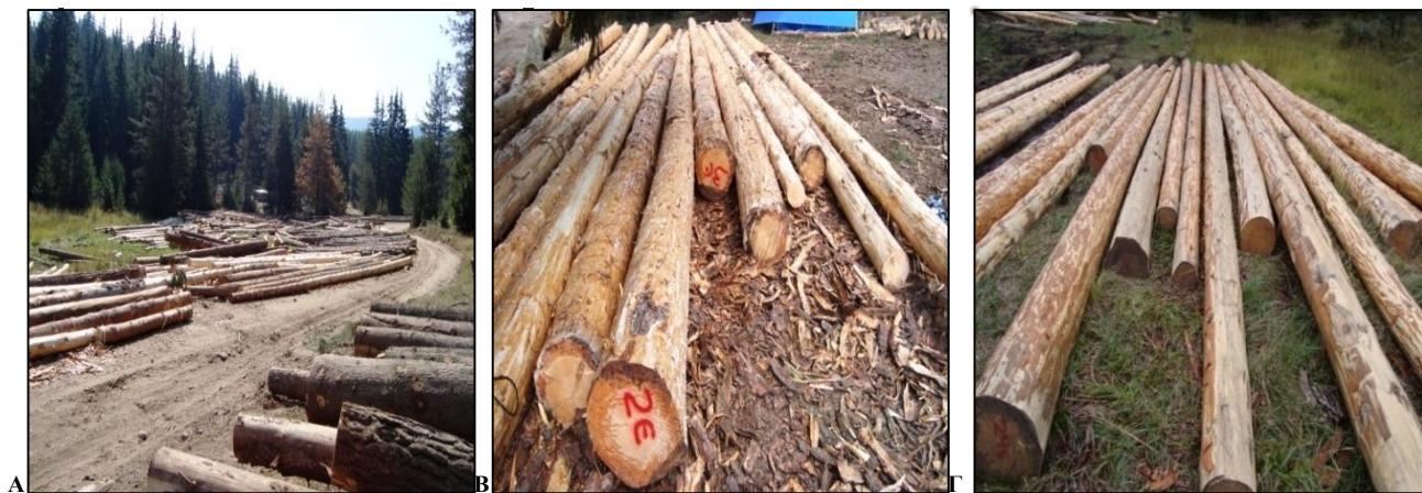
Εικόνα 6.3 Παραγωγή στύλων ΔΕΗ από ελληνικά δάση μαύρης και δασικής πεύκης (Α:θέση «Βαθύρεμα» Δράμας). Β, Γ: Αποφλοιωμένοι στύλοι δασικής πεύκης (Koutsianitis & Voulgaridis, 2014).
