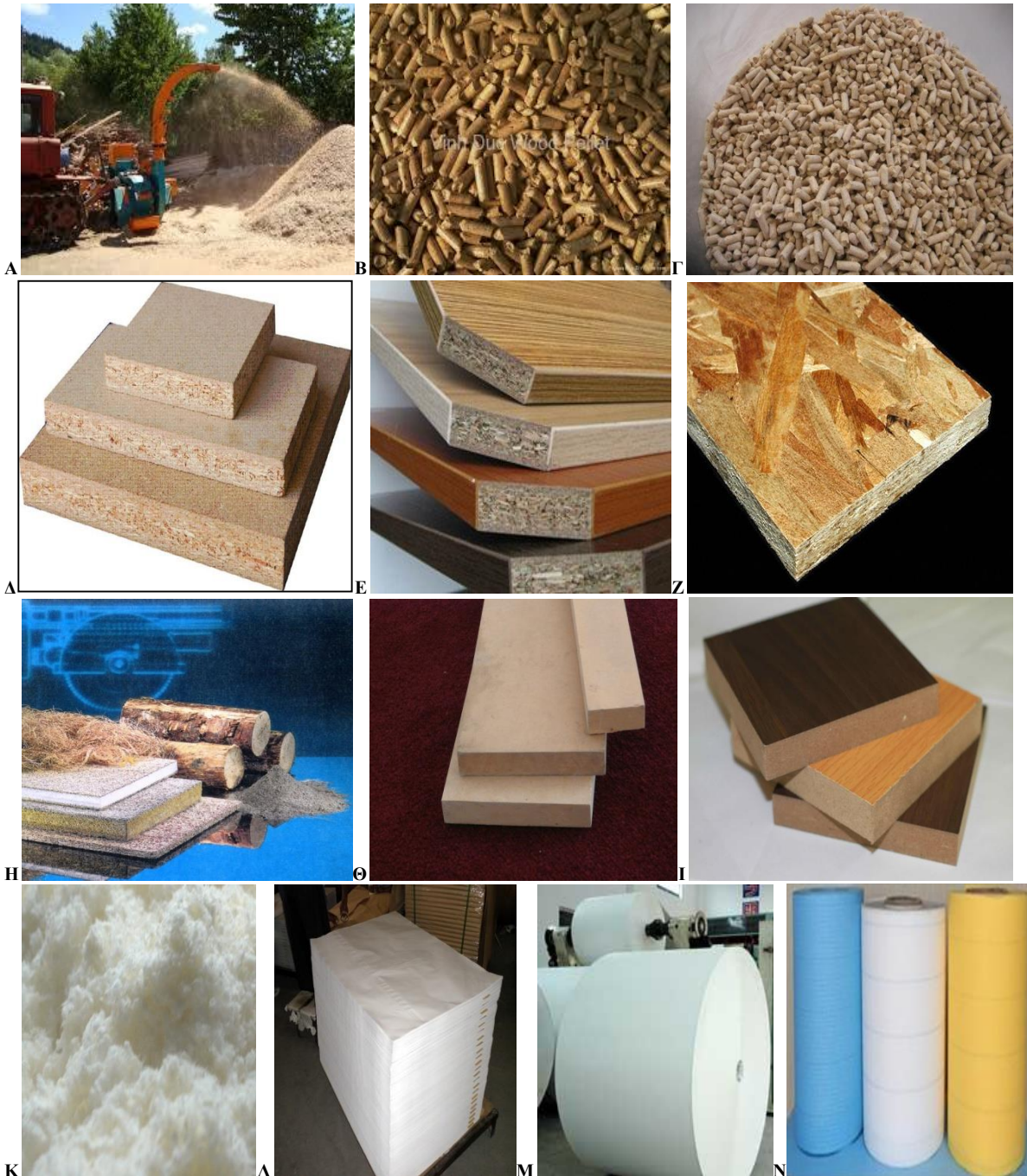
Εικόνα 3.20 Παραγωγή ξυλοτεμαχιδίων (Κ) σε θρυμματιστή για παραγωγή πελλετών (Β,Γ), προϊόντων σε μορφή πλάκας (Α-Ι) και ξυλοπολτού (Κ,Λ) και χαρτιού (Μ,Ν). Α, Ε: Μοριοπλάκες, μη επενδεδυμένες (Α) και επενδεδυμένες (Ε). Ζ: Μοριοπλάκα ειδικού τύπου με διακοσμητικά πλανίδια (waferboard), Η: Παραγωγή ξυλερίου και συνδυασμός ξυλοτεμαχιδίων με τσιμέντο για παραγωγή τσιμεντοπλακών. Θ,Ι: Ινοπλάκες μη επενδεδυμένες (Θ) και επενδεδυμένες (Ι) (Βουλγαρίδης, 2015).
