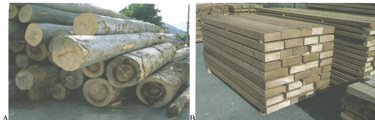
Εικόνα 9.4 Ερυθρό εγκάρδιο όπως φαίνεται στις εγκάρσιες επιφάνειες κορμοτεμαχίων οξιάς (Α) και επίτευξη ομοιόμορφου χρώματος μετά από άτμιση πριστής ξυλείας (Β) (Κακαράς, 2009).
