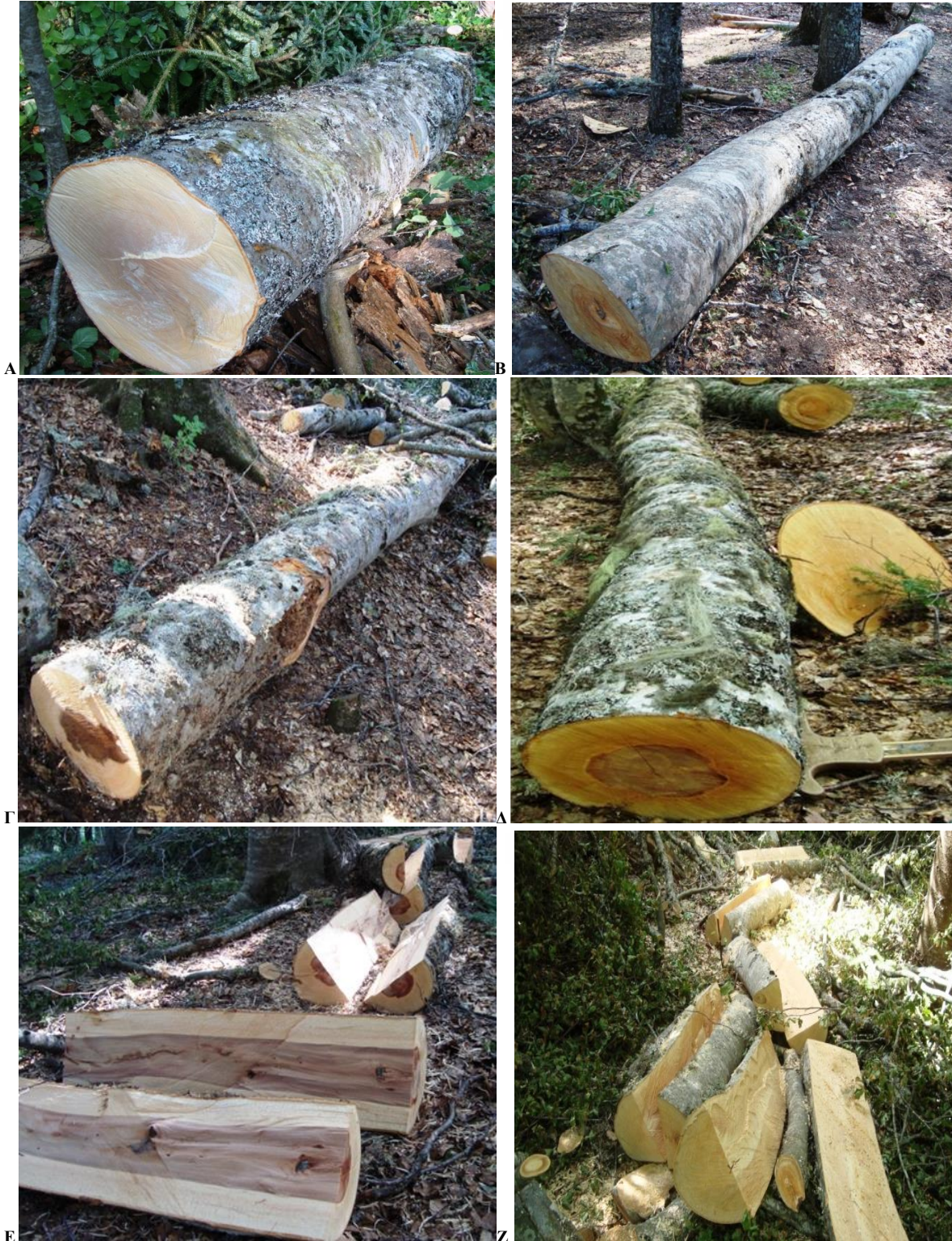
Εικόνα 6.2 Α, Β, Γ, Δ : Ποιοτική ταξινόμηση κορμοτεμαχίων οξιάς στις ποιοτικές κλάσεις Α', Β', Γ', και Δ', αντίστοιχα, σύμφωνα με το πρότυπο EN 1316-1 (1997). Ε, Ζ: Στοιβαζόμενο ξύλο (ξύλο θρυμματισμού, καυσόξυλο) (Κουτσιανίτης, 2015).
