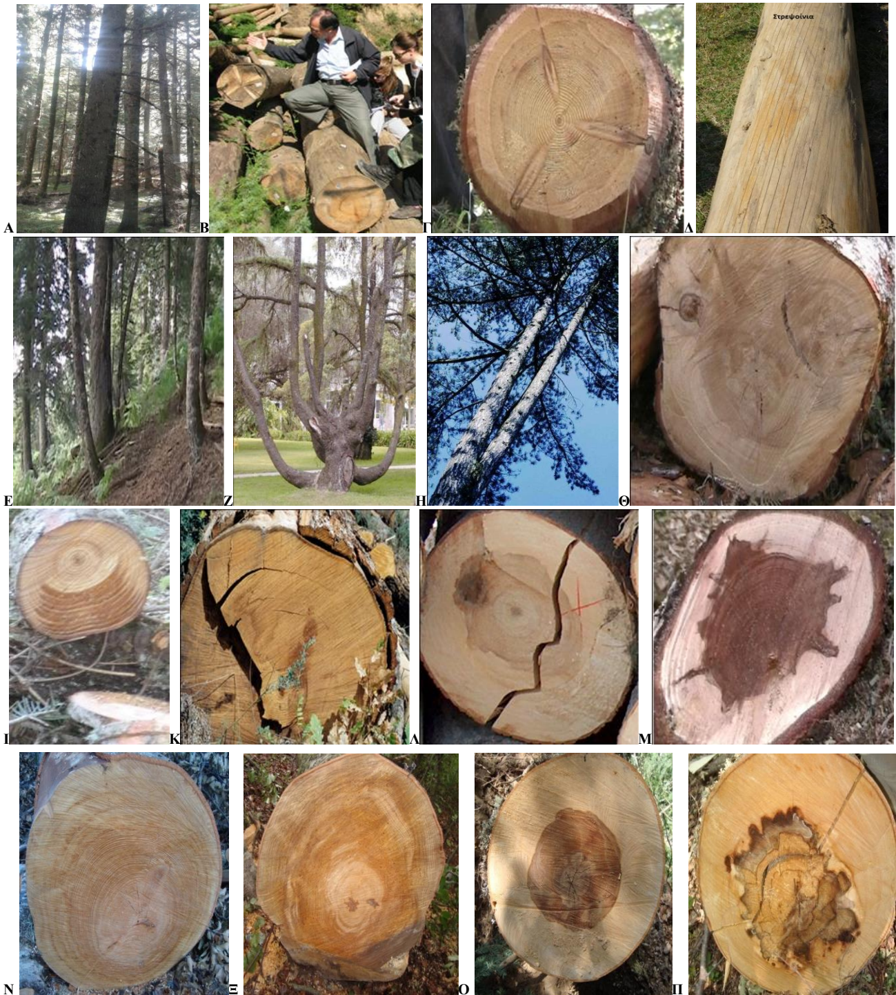
Εικόνα 3.7 Σφάλματα ξύλου σε ελάτη (Α-Μ) και οξιά (Ν-Π). Α: Κλαδοβρίθεια σε δέντρο που δεν υπέστη τεχνητή κλάδευση. Β, Γ: Ρόζοι. Δ: Στρεψοίγια και επιφανειακές ραγαδώσεις σε κορμοτεμάχιο ελάτης λόγω επιφανειακής ξήρανσης μετά την αποφλοιώση, Ε: Αποκλίσεις κορμών από την τυπική κατακόρυφη θέση. Ζ: Δημιουργία πολυελαίου στη βάση του δέντρου. Η: Διχάλωση που προκαλεί διπυρήνωση. Θ: Διπυρήνωση σε εγκάρσια τομή λόγω διχάλωσης. Ι: Θλιψιγενές ξύλο. Κ: Περιφερειακή ραγάδα σε καστανιά. Λ: Ραγάδα σε ξύλο λεύκης μετά τη ρίψη. Μ: Υγρό εγκάρδιο ελάτης. Ν, Ξ: Εφελκυσμογενές ξύλο και εκκεντρότητα σε ξύλο οξιάς. Ο: Ερυθρό εγκάρδιο σε ξύλο οξιάς. Π: Ερυθρό εγκάρδιο ακανόνιστης διατομής και σήψη σε ξύλο οξιάς (Βουλγαρίδης, 2015).
