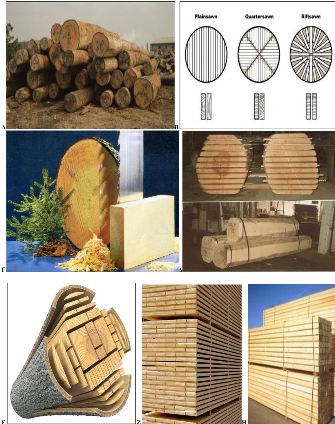
Εικόνα 3.17 Κορμοτεμάχια για πρίση (Α), εφαπτομενικός, κατά τεταρτημόριο και ακτινικός τρόπος πρίσεως για παραγωγή ακτινικής σχεδίασης (Β), ανάπτυξη δέντρου από το φυτάριο και δημιουργία κορμοξύλου, πρίση κορμοτεμαχίου και παραγωγή πριστής ξυλείας και ξυλοτεμαχιδίων (Γ), πρίση εφαπτομενικά με τους αυξητικούς δακτυλίους (πάνω) και διαμόρφωση κορμοτεμαχίων για παραγωγή διακοσμητικών ξυλοφύλλων (κάτω), (Δ), δυνατότητες εφαρμογής τρόπων πρίσης και παραγωγής πριστών σε εγκάρσια τομή κορμοτεμαχίου (Ε) και πριστή ξυλεία (Γ,Ζ,Η) Βουλγαρίδης, 2015; Δ. Βουλγαρίδης κ.ά., 2002).
