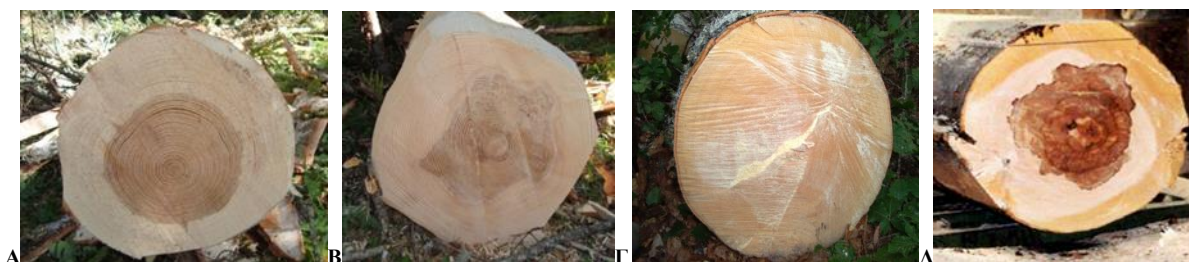
Εικόνα 3.8 Εμφάνιση «υγρού εγκάρδιου» με κανονική (κυκλική) διατομή (Α) και ακανόνιστη διατομή (Β) στη βάση κορμοτεμαχίων υβριδογόνου ελάτης. Κορμοτεμάχιο οξιάς χωρίς ερυθρό εγκάρδιο (Γ) και με ακανόνιστο ερυθρό εγκάρδιο (Δ) (Α, Β, Γ : Κουτσιανίτης, 2015; Δ: Αδαμόπουλος, 2014).
