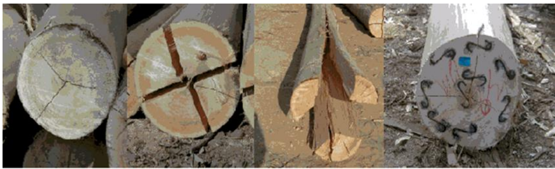
Εικόνα 3.12 Ραγαδώσεις ή σχίσσιμο των άκρων και κατά μήκος των κορμοτεμαχίων και προφύλαξη με συνδετήρες (δεξιά) (Wimmer, 2015).
