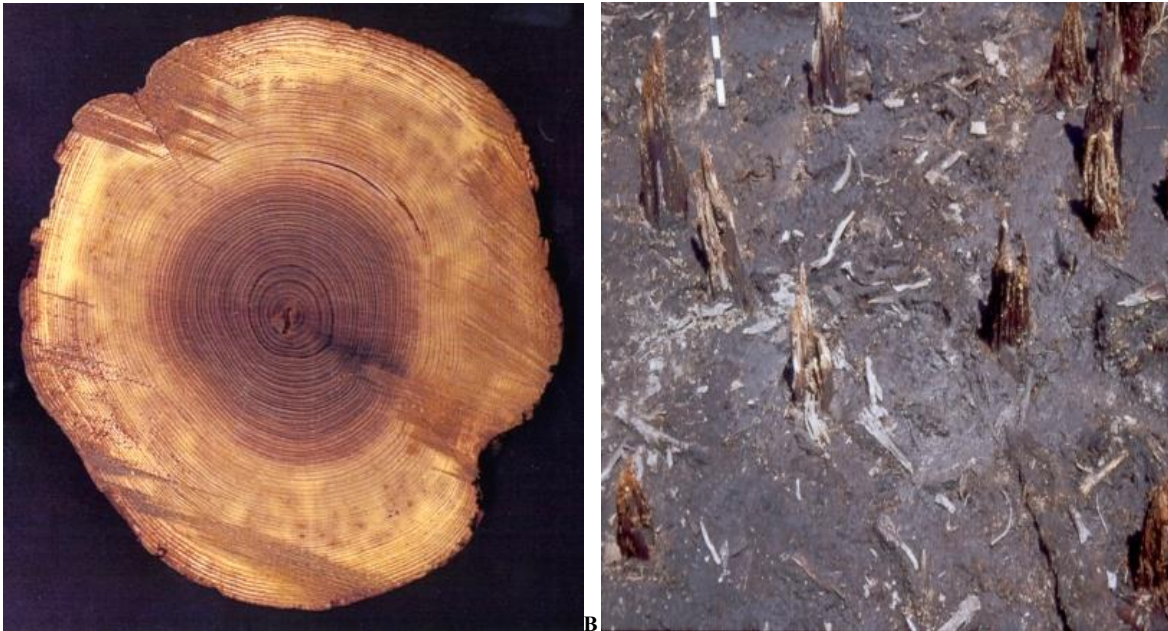
Εικόνα 3.26 Εγκάρσια τομή πασσάλου από ξύλο Juniperus (Α) από το λιμναίο οικισμό Δισπηλιού Καστοριάς(Β) σε καλή κατάσταση μετά από 5.500 χρόνια λόγω της πολύ καλής φυσικής αντοχής του μετά από μακροχρόνια παραμονή του μέσα στο νερό (Voulgaridis, 2005; Βουλγαρίδης, 2015).
