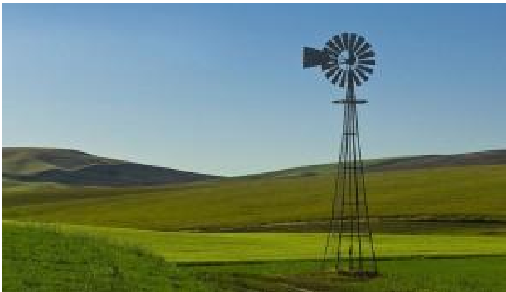
Εικόνα 1.2 : Ανεμόμυλος τύπου «western wheel».
