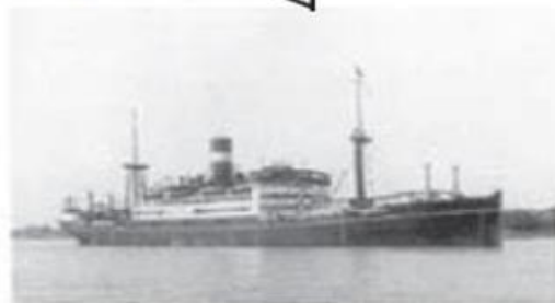
Πλοίο γραμμών μεταφοράς φορτίων: πολλαπλά καταστρώματα, βαθιές δεξαμενές, ανελκυστήρας βαρών, ψυγείο, κουκέτες επιβατών, κ.τ.λ. Πιο γρήγορο από πλοίο αναύλωτης ναυτιλίας, π.χ. 12 κόμβοι
