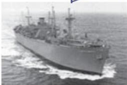
Βασικός σχεδιασμός πλοίων αναύλωτης ναυτιλίας: διπλό κατάστρωμα, γερανός και οικονομικές ταχύτητες, π.χ. 10 κόμβοι
