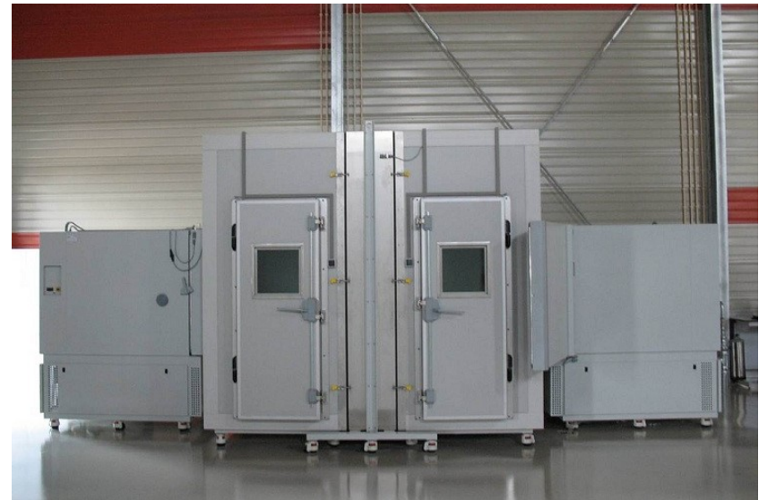
Πειραματική εγκατάσταση μέτρησης συντελεστή U_c
