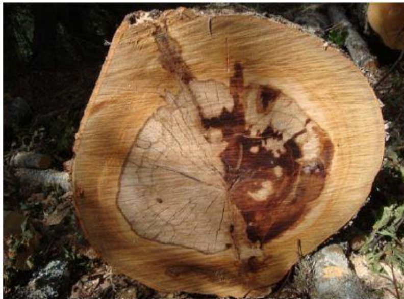
Εικόνα 5.6.5. Ταξινόμηση στρογγύλης ξυλείας οξιάς στην ποιοτική κλάση Δ, σύμφωνα με το πρότυπο EN 1316-1 1997 CEN.
