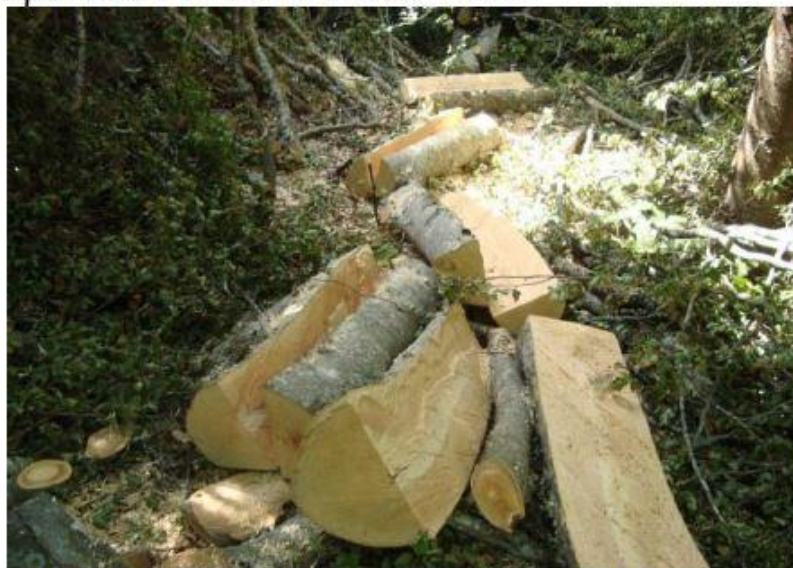
Εικόνα 5.6.6. Ξυλεία οξιάς που εξαιτίας της έντασης των σφαλμάτων της δεν κατατάσσεται σε καμία από τις ποιοτικές κλάσεις σύμφωνα με το πρότυπο EN 1316-1 1997 CEN και προορίζεται για ξύλο θρυμματισμού και καυσόξυλο.
