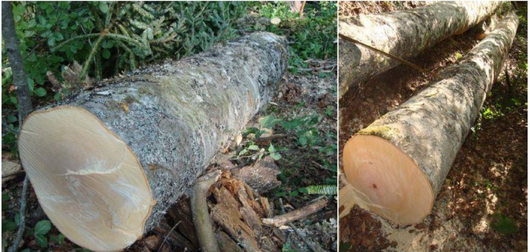
Εικόνα 5.6.2. Ταξινόμηση στρογγύλης ξυλείας οξιάς στην ποιοτική κλάση A, σύμφωνα με το πρότυπο EN 1316-1 1997 CEN.
