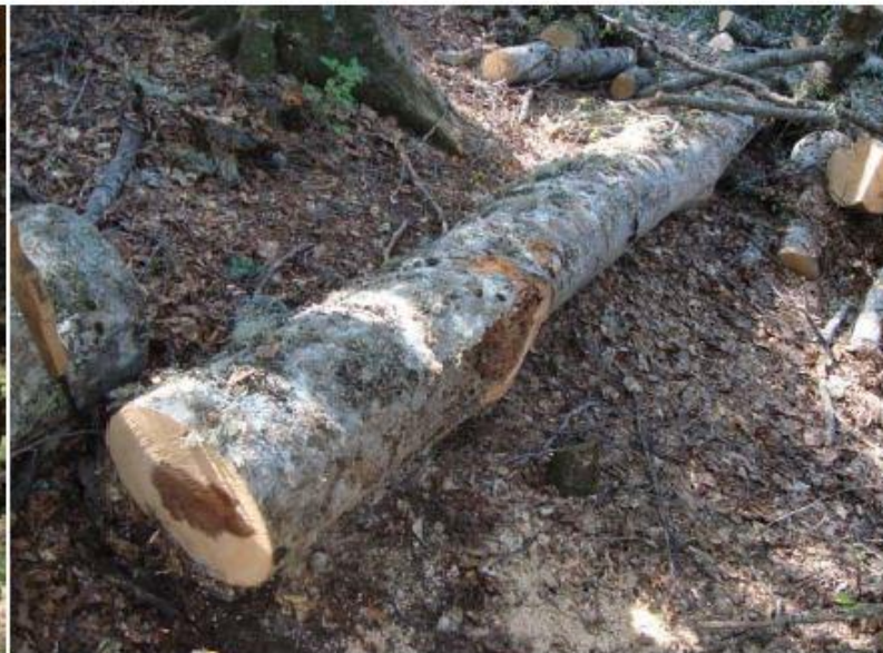
Εικόνα 5.6.5. Ταξινόμηση στρογγύλης ξυλείας οξιάς στην ποιοτική κλάση Δ, σύμφωνα με το πρότυπο EN 1316-1 1997 CEN.
