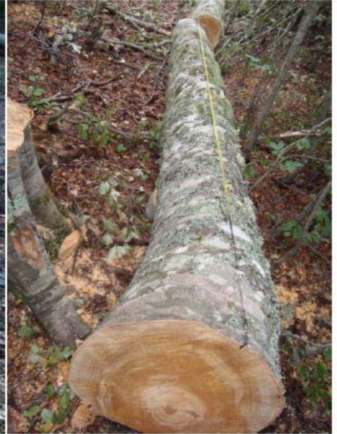
Εικόνα 5.6.3. Ταξινόμηση στρογγύλης ξυλείας οξάς στην ποιοτική κλάση Β, σύμφωνα με το πρότυπο EN 1316-1 1997 CEN.
