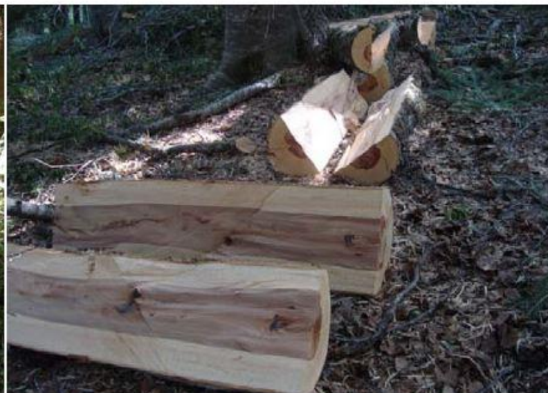
Εικόνα 5.6.6. Ξυλεία οξιάς που εξαιτίας της έντασης των σφαλμάτων της δεν κατατάσσεται σε καμία από τις ποιοτικές κλάσεις σύμφωνα με το πρότυπο EN 1316-1 1997 CEN και προορίζεται για ξύλο θρυμματισμού και καυσόξυλο.
