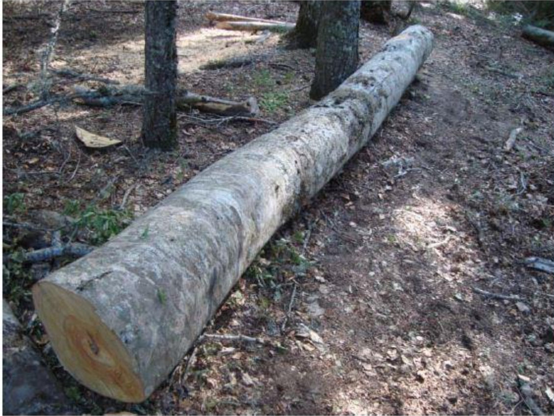
Εικόνα 5.6.3. Ταξινόμηση στρογγύλης ξυλείας οξάς στην ποιοτική κλάση Β, σύμφωνα με το πρότυπο EN 1316-1 1997 CEN.
